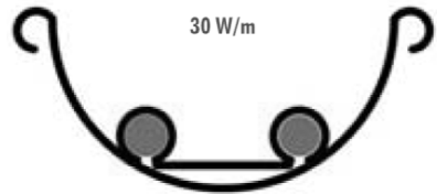
Bild 4: Querschnitt Halbrund-Dachrinne mit Heizkabel und Abstandshalter
